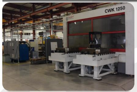
Горизонтальный 4-х координатный обрабатывающий центр с размером стола 1000×1000 мм Heckert CWK 1250.
